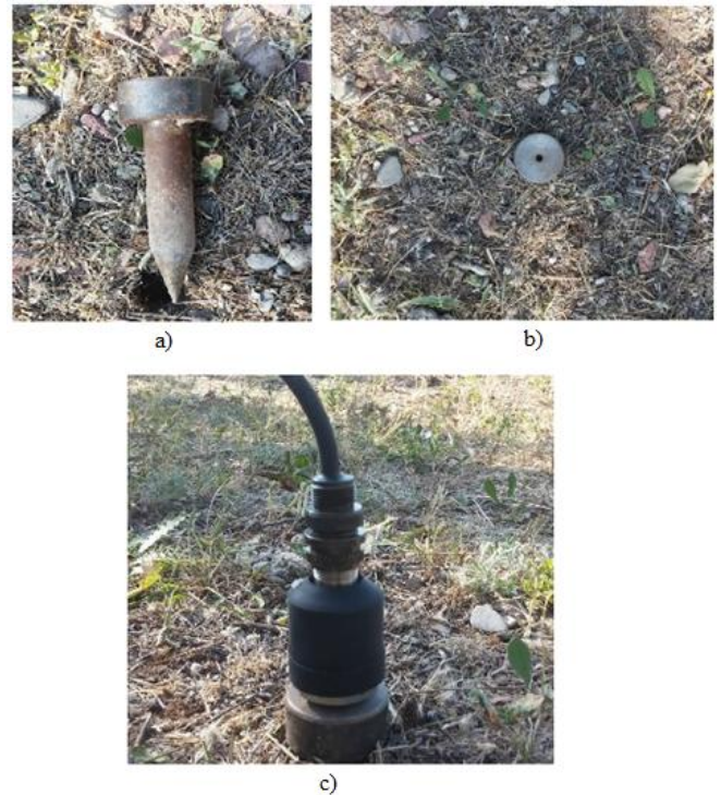
Şekil 2. (a) Kazık (b) Kazığın toprağa saplanması (c) Kazık üzerine ivmeölçerin bağlanması
