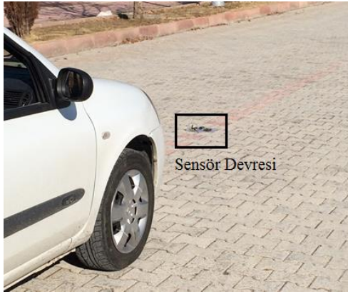
Şekil 8. Otomobilin sensör devresine yaklaşması
